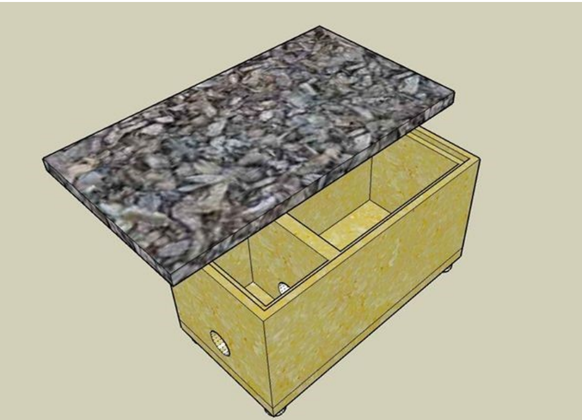
Figur 11: Liten humle kasse med to rom. Kassa kan godt bare ha ett rom også. Da kan lengden godt reduseres til 25 cm. Ved to rom plasseres musebolet i det bakerste rommet. Denne kassa ble brukt mye i starten.
